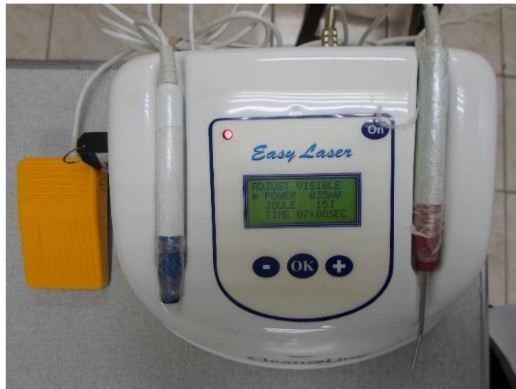
Figura 3 - Laser de Arseneto de Gálio e Alumínio (Easy Laser, Clean Line, Taubaté, Brasil).
